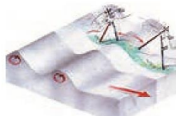
شکل ۲-۴. نحوه حرکت موج سطحی L
